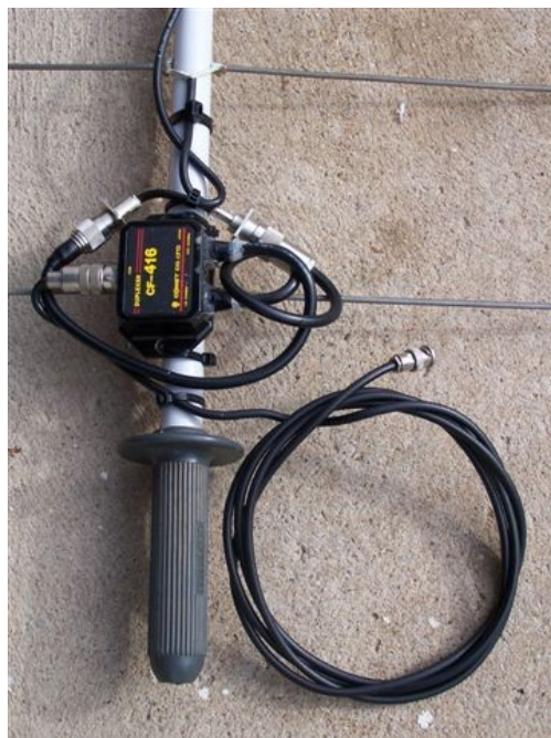
Foto 4: Detalle de fijación de los elementos al boom y conexión del coaxial al elemento radiante
